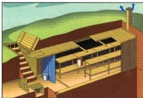
Отдельно стоящее противорадиационное укрытие из лесоматериалов
