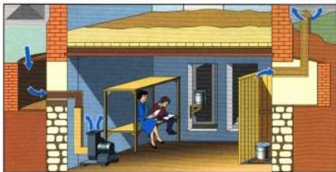
Подвал одноэтажного здания, приспособленный под противорадиационное укрытие
